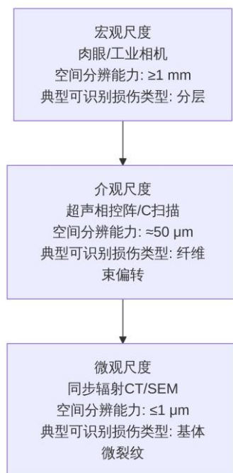
图 1. 复合材料冲击损伤多尺度表征技术层级图
